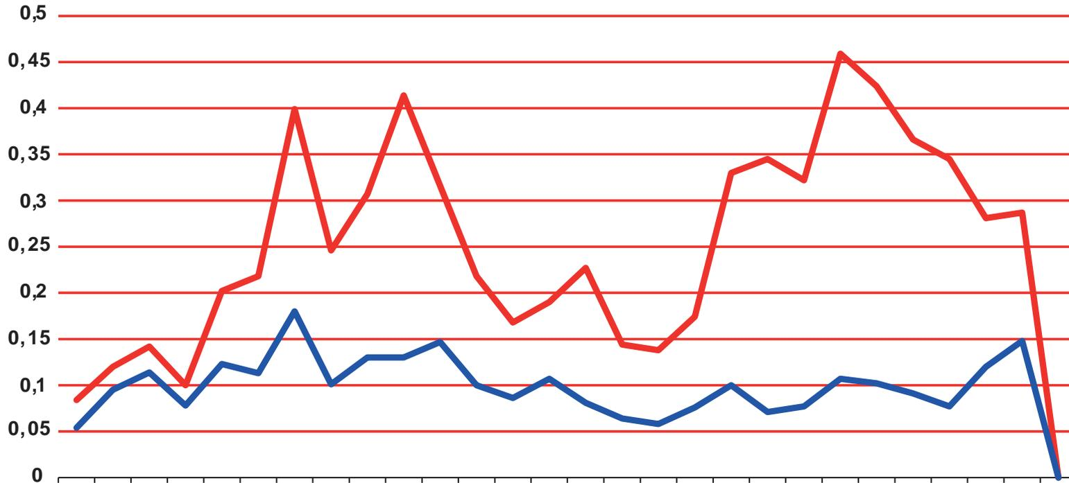
Rote Linie: Beschleunigungswerte am Fahrzeugboden unter dem Hoverboard
