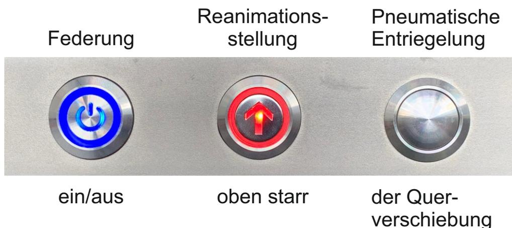
Durch Drücken eines der Entriegelungstaster öffnet die Verriegelung der Querverschiebung (Option) pneumatisch. Solange der Taster gedrückt bleibt, kann das Hoverboard in 8 Positionen zu je 32 mm (= gesamt 256 mm) verschoben werden. Bei Loslassen des Tasters verriegelt das Hoverboard in der nächstliegenden Position.
