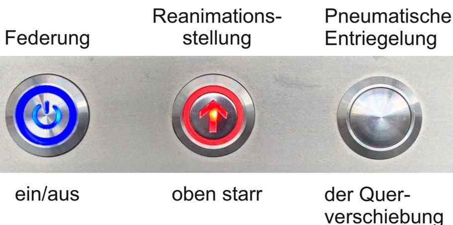
Durch Drücken eines der Entriegelungstaster öffnet die Verriegelung der Querverschiebung (Option) pneumatisch. Solange der Taster gedrückt bleibt, kann das Hoverboard in 8 Positionen zu je 32 mm (= gesamt 256 mm) verschoben werden. Bei Loslassen des Tasters verriegelt das Hoverboard in der nächstliegenden Position.
