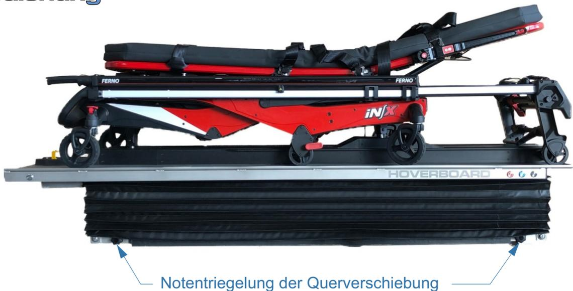
Die pneumatische Entriegelung wird aus dem Luftvorratstank gespeist, der nur bei eingeschaltetem Hauptschalter nachgefüllt wird. Ständiges Auslösen bei ausgeschaltetem Hoverboard führt daher zu vorübergehender Fehlfunktion.
