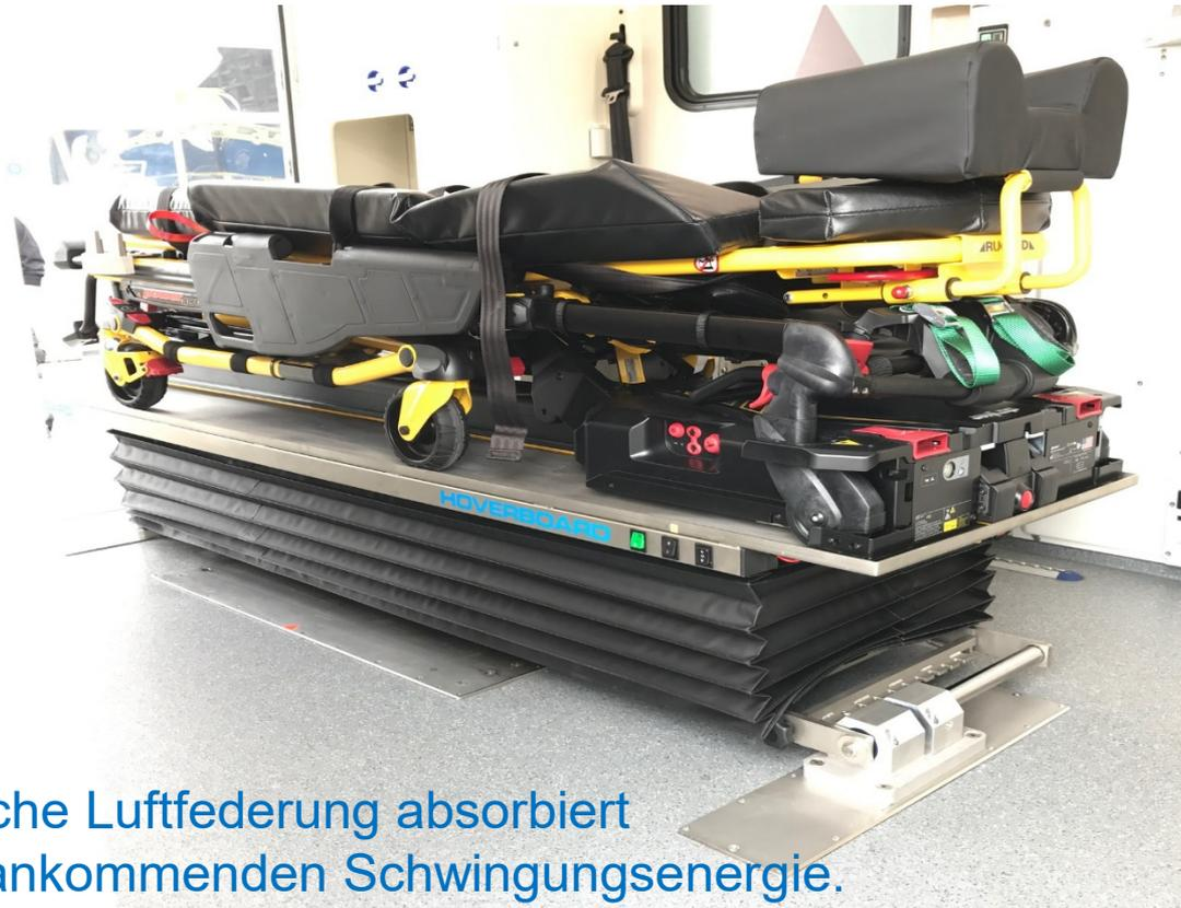
Die vollautomatische Luftfederung absorbiert den Großteil der ankommenden Schwingungsenergie.
