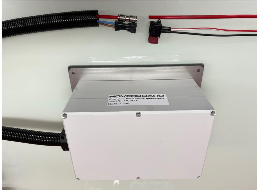
Diese Box wird mit einer Montageplatte aus Edelstahl an der Fahrzeugunterseite montiert.
