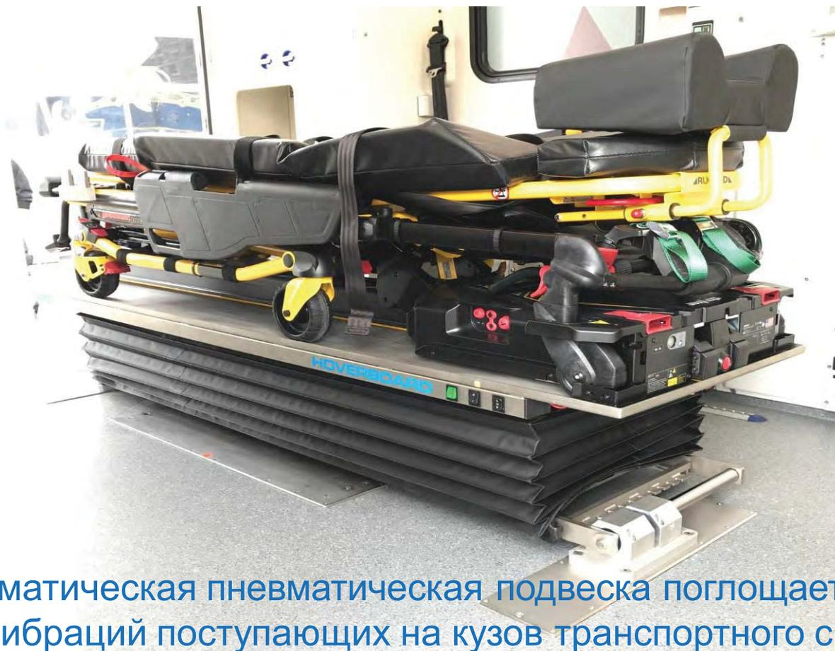
Полностью автоматическая пневматическая подвеска поглощает большую часть вибраций поступающих на кузов транспортного средства.
